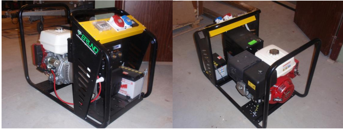
220 A līdzstrāvas metināmais agregāts ar 6.7 kVA (5.4 kW) elektrostaciju Bruno (Itālija), 230/400 V, Honda benzīna motors, rokas spoles un elektriskais starts, . Cena 1 400,- LVL ar PVN
