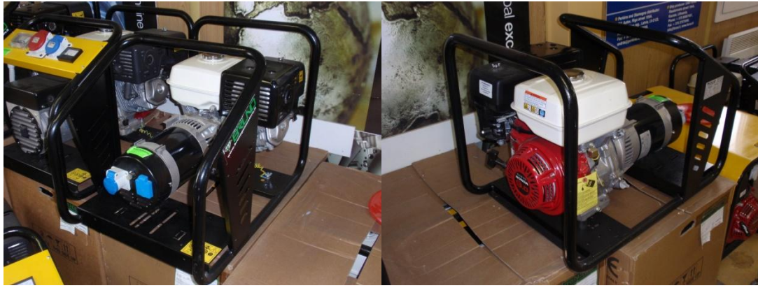
5 kVA (4 kW) Bruno (Itālija) elektrostacija, 230 V, Honda benzīna motors, rokas spoles starts, 1.5 l/h degvielas patēriņš pie 75% slodzes, 6 l degvielas tvertne. Cena 520,- LVL ar PVN
