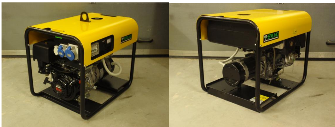
5 kVA (4 kW) Bruno (Itālija) elektrostacija, 230 V, Honda benzīna motors, rokas spoles starts, 1.5 l/h degvielas patēriņš pie 75% slodzes, 20 l degvielas tvertne. Cena 820,- LVL ar PVN
