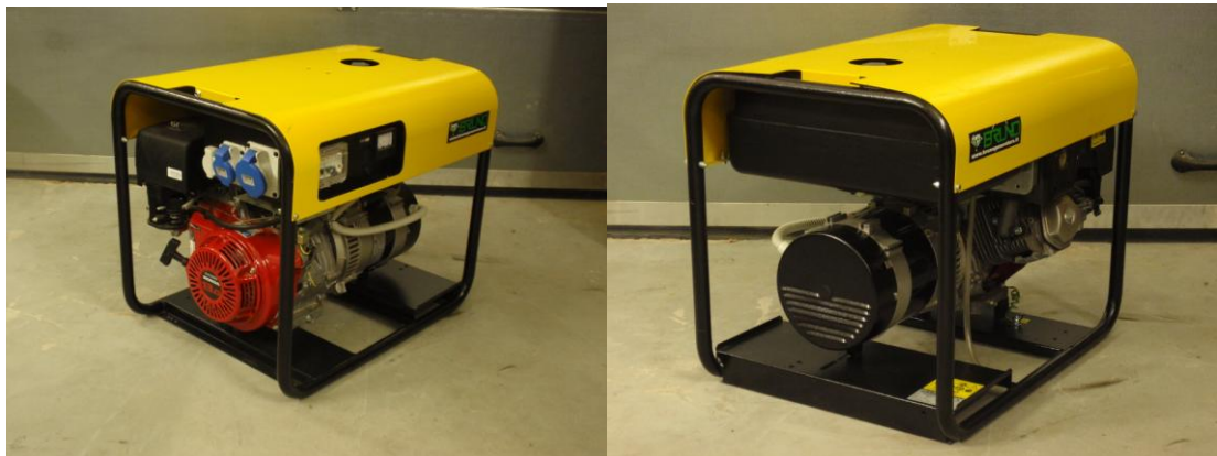
7.5 kVA (6 kW) Bruno (Itālija) elektrostacija, 230 V, Honda benzīna motors, rokas spoles starts, 1.9 l/h degvielas patēriņš pie 75% slodzes, 20 l degvielas tvertne. Cena 1 010,- LVL ar PVN
