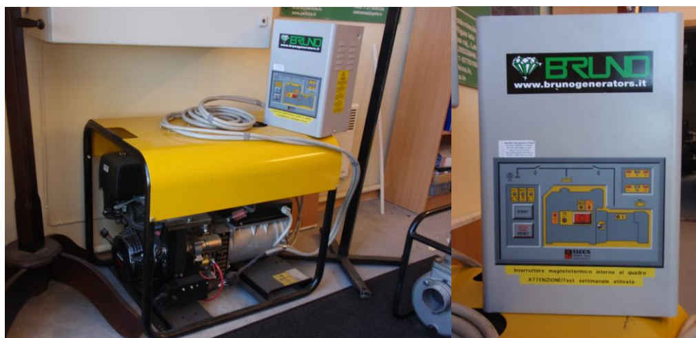
8.3 kVA (6.6 kW) Bruno (Itālija) elektrostacija, 230/400 V, Honda benzīna motors, ARI sistēma (automātiskā palaišana), 1.9 l/h degvielas patēriņš pie 75% slodzes, 20 l degvielas tvertne. Cena 1 800,- LVL ar PVN
