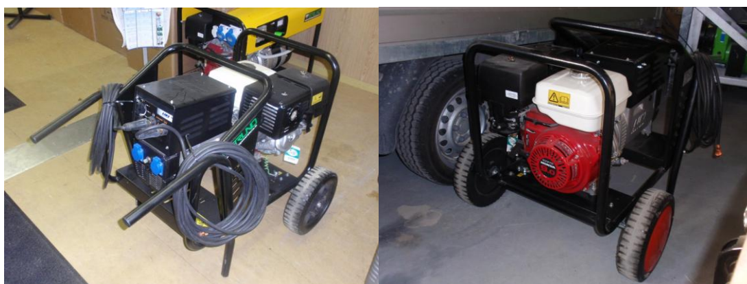
160 A līdzstrāvas metināmais agregāts ar 3.4 kVA (2.7 kW) elektrostaciju Bruno (Itālija), 230 V, Honda benzīna motors, rokas spoles starts, . Cena 1 070,- LVL ar PVN
